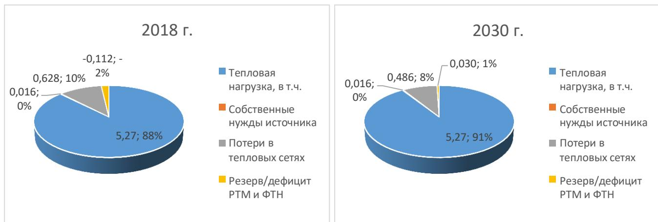
**Рисунки 3.3.2-3.3.3 – Структура нагрузок и резервов тепловой мощности котельных ОАО «СТВК»**
